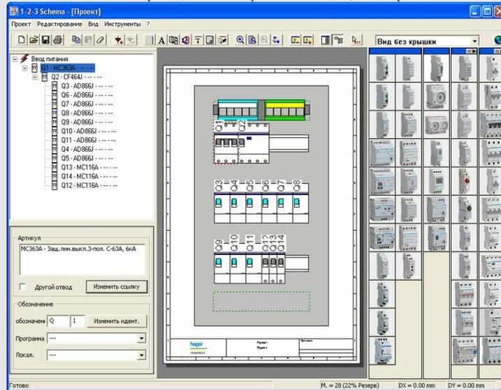
распечатать электрическую схему щитка и этикетки с обозначениями элементов схемы для щитка
